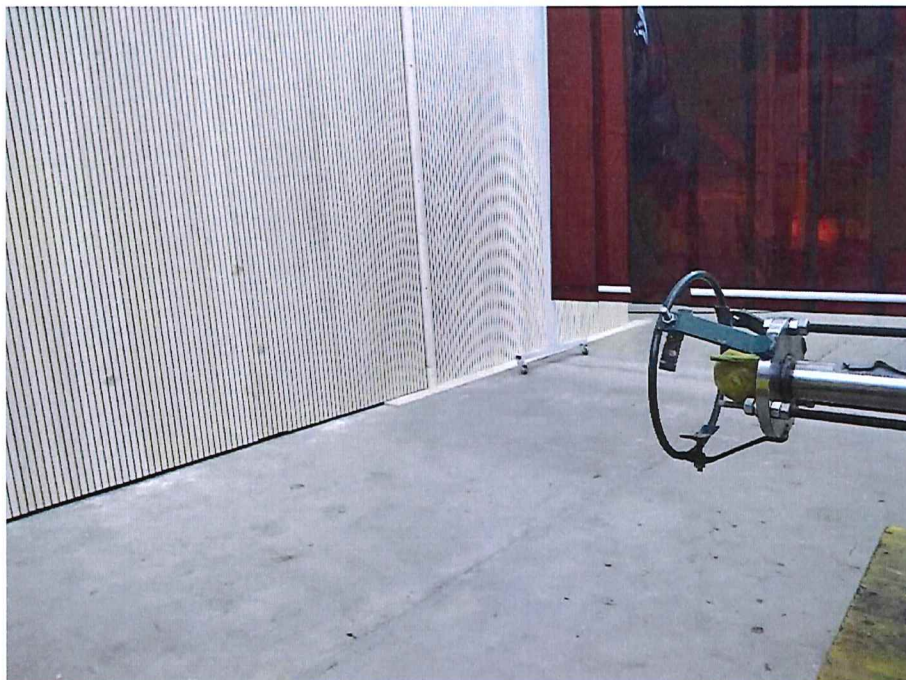
Abbildung A2-2: Versuchsaufbau Wandelement, Auftreffwinkel 90° - Hockeyball
